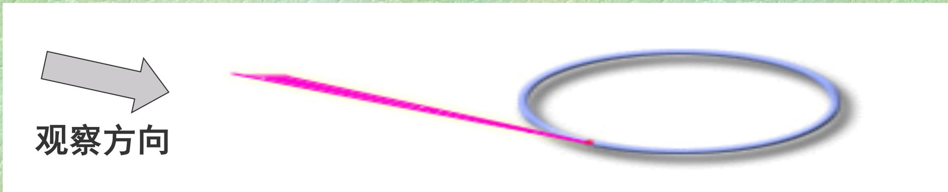
电子储存环：当电子束团以相对论速度在储存环中运行时，在弯转磁铁或其他插入器件磁场作用下，电子束团受到向心力作用而发生偏转，同时产生特定形式的电磁辐射，即同步辐射。同步辐射是沿电子运动切线方向出射的一束高准直的广谱电磁辐射，其能量覆盖从可见光到几百KeV的硬X射线，一般称为白光。同步辐射具有高强度，高准直，发射角小，广谱，具有时间结构，有偏振性，有一定的相干性，可准确计算等一系列优点。
